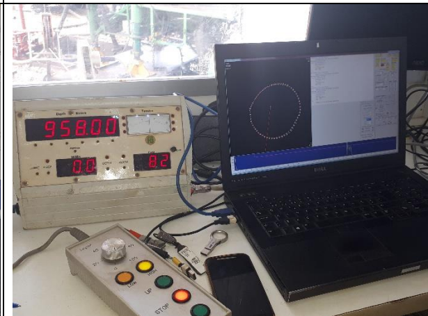
Foto 10 – Leitura da profundidade e tensão do sonar.
